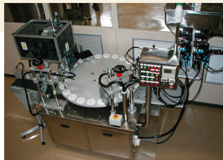
機械名：サンプルジャー充填機（シバタMS-KC型） 機械メーカー：株式会社シバタエンジニアリング 充填量：3g～20g 標準能力：20～40ヶ/分（容器形状およびバルク性状による） 充填方式：ハイパーポンプ2ヘッド式 （高性能シリンダー・ピストン2ヘッド方式） 通液部：SUS304製および特殊樹脂製 ※基本的に、容器の形状毎に、ホルダー（24個）が専用部品として必要になります。
